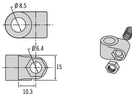
可调连杆导向套零件号(包括两个连杆导向套、两个弹簧和两个M6螺母)
