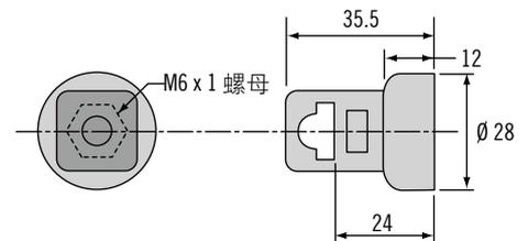
固定连杆导向套零件号(提供一个导向套)
