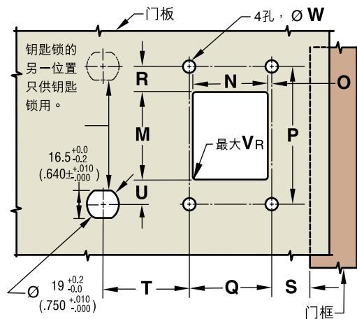
2. 将遮盖板的螺栓插入孔中，然后装上门锁，拧紧螺母/锁紧垫圈组件。
